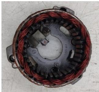
la terza ed ultima causa lo Statore. Smontato, pulito e controllato con il tester senza riscontrare nessun problema. Anche le spazzoline erano OK (anche se non potevano essere sicuramente loro la causa).
