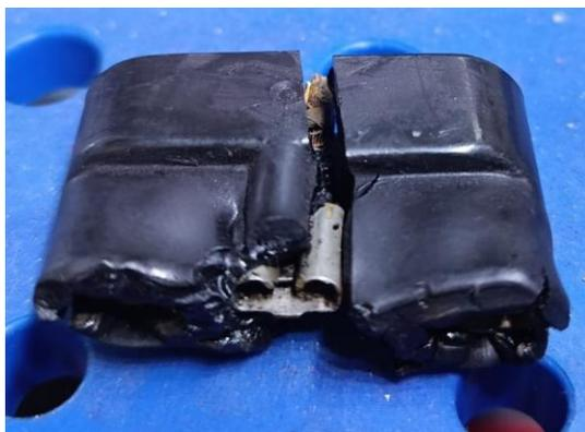
Nel rimontare il tutto mi accorgo del connettore di bachelite che aveva segni di deformazione a causa di eccessivo calore generato da resistenza.
